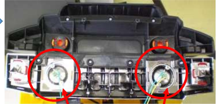
フロント部分の裏側からライトを固定しているネジを外します
