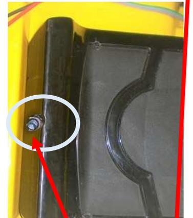
右側面、後部、左側面の3か所をネジで固定します
