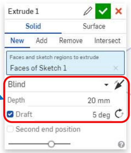
● 押し出しExtrudeでBlindで押し出し距離20mmで押し出す
