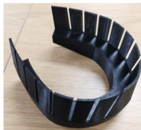
装蹄療法用3Dプリント樹脂蹄鉄 右: CADモデル, 左: 印刷物
