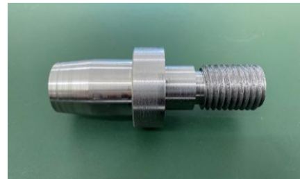
(図 2 外径削り、テーパ削り、溝削り、ねじ切り)
