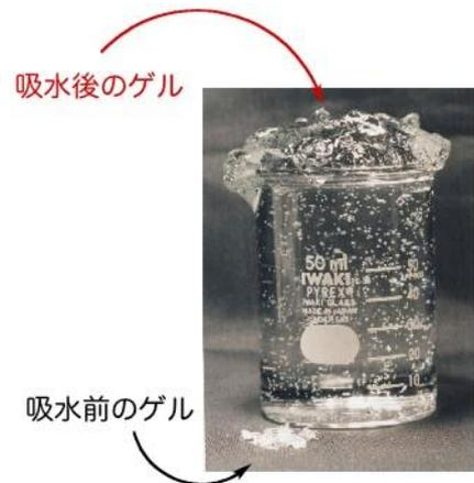
例2. 刺激応答性高分子の合成とその機能評価
