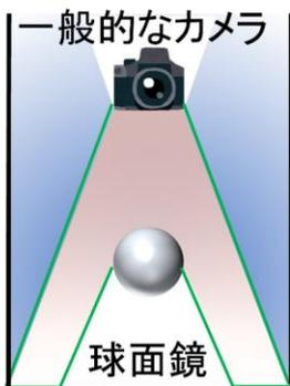
凸面鏡を構成する反射屈折撮像系
