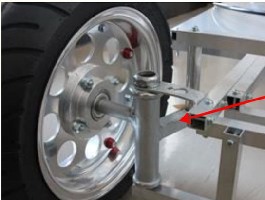
前輪ステアリング機構を廃棄自転車のハンドル回転部品で製作した。
