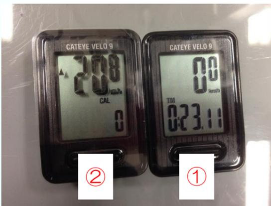
ブレーキタイヤ①とフリータイヤ②の速度を表示し、その速度差で滑り具合を確認する。
