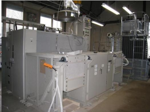
図2 高周波誘導溶解炉
