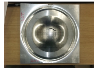
図 2 破断時の試験片 (試験片にあらかじめスタンプされた格子模様の変形状態を基に、成形限界ひずみを決定)
