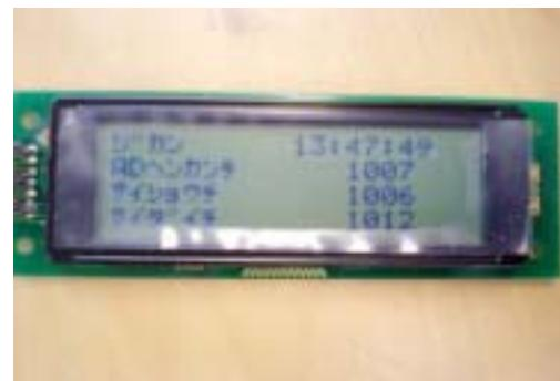
図 4.2 動作時の液晶部
